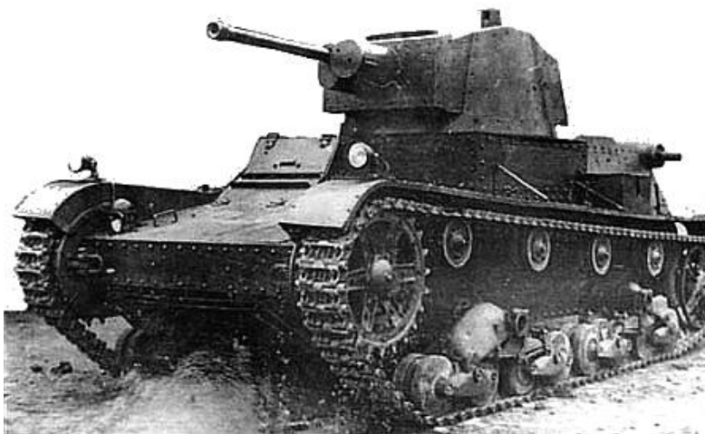
Polski czołg lekki TP7 – zmodyfikowany i udoskonalony czołg angielski marki Vickers (Wikipedia), wersja z jednym działem kaliber 37 mm (produkowanej w Polsce na szwedzkiej licencji Boforsa)..
